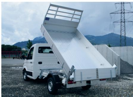
Nulla è più versatile del pratico Crafter Swiss Champion con cassone ribaltabile su 3 lati, disponibile come cabina singola e doppia in due passi ruote. Il carico utile è di circa 1050 kg per la cabina singola con passo ruota di 3640 mm.\*
